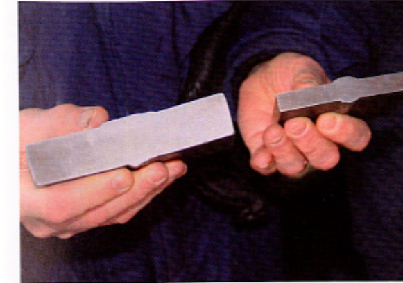
Laivojen rakenteet poikkeavat merkittävästi kestävyydeltään. Vasemmalla jäänmurtajan ja oikealla kauppalaisen teräsrakennellevyjä.
